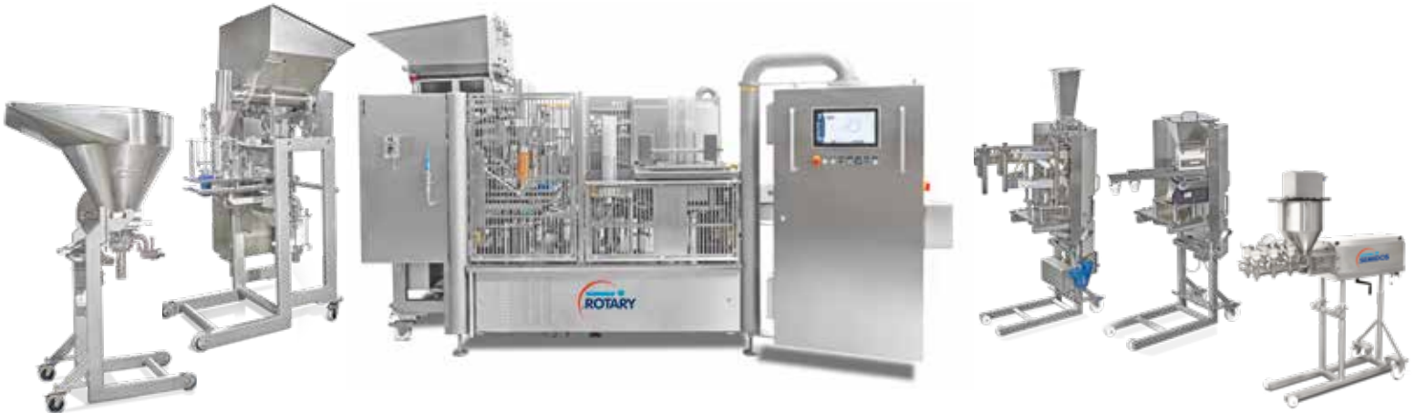
GRUNWALD-FLEXODOS für nicht pumpfähige Produkte, angekoppelt in der Dock-In-Station einer Becherfüllanlage Typ GRUNWALD-ROTARY 12.000. An derselben Position kann ein weiterer Beistelldoseur (z.B. MOBIFILL - links im Bild - für pumpfähige Produkte) im Austausch andockt werden.
