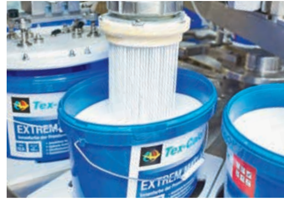
Dosierstation mit höchster Dosiergenauigkeit (≤ 0,1 % Standardabweichung)
