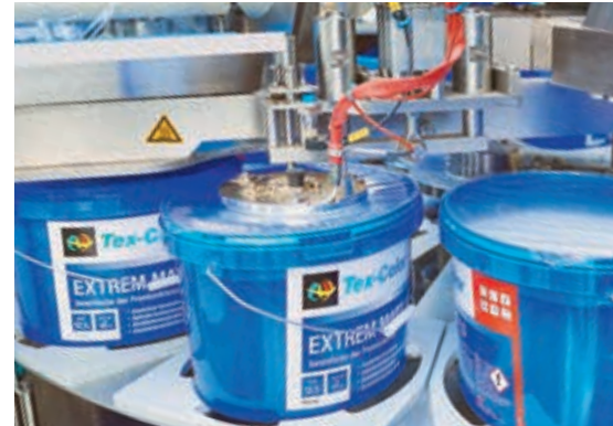
Dichtheitskontrolle der mit peelfähiger Sicherheitsfolie versiegelten Eimer
