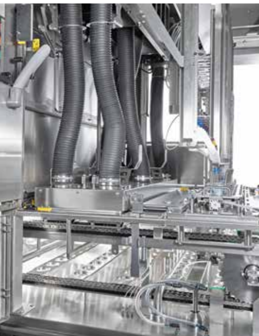
zweifach pulsed light Hochleistungs-UV(C)-Becherentkeimung mit einer garantierten Entkeimungsrate von mind. LOG 4
