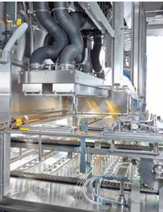
zweifach pulsed light Hochleistungs-UV(C)-Becherentkeimung mit einer garantierten Entkeimungsrate von mind. LOG 4
