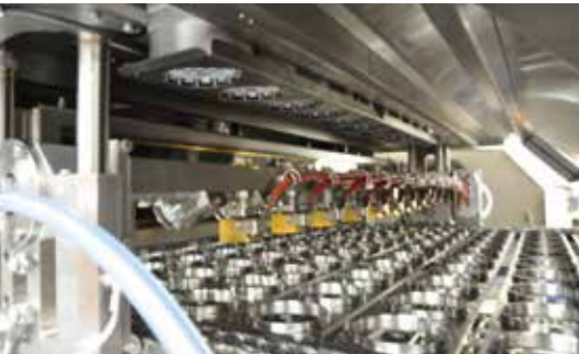
Platinensetzer mit Heftstation
