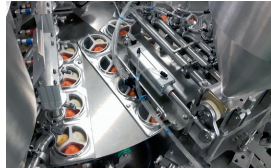
Abfüllung verschiedener Hummusprodukte in 3-Kammerbecher
