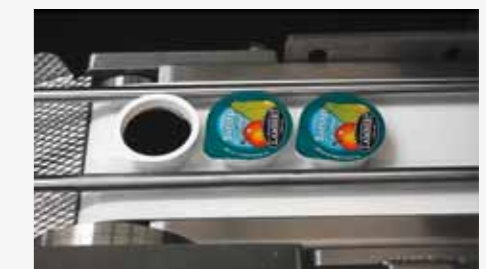
Fotos von oben nach unten: (1) optimal ausgelegte Dosierstation (2) Rundläufer für Becher mit Siegelplatinenverschluss, wahlweise mit zusätzlichem Stülpedeckel (3) „Stroop“ in Bechergrößen von 15 g – 80 g
