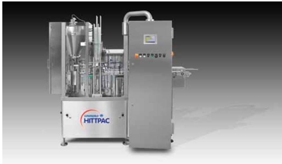
Der im Jahr 2012 gelieferte Becherfüller GRUNWALD-HITPAC AKH-019S/2 zur Abfüllung von Dips und Saucen in runde Kunststoffbecher Produktionsleistung: bis 5.000 Becher / Stunde
