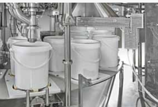
2-bahnige, wiegezellen-gesteuerte Füllstation
