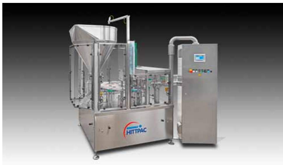
GRUNWALD-HITPAC 029S/1 zur Abfüllung von Kartoffelsalat in rechteckige und runde Kunststoffbecher, 500 g und 1 kg Produktionsleistung: bis ca. 1.800 Becher / Stunde
