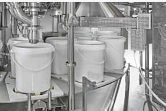
2-bahnige, wiegezellen-gesteuerte Füllstation
