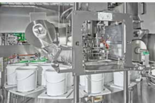
Siegel-Stanz-Station für Folie von der Rolle mit einfachem und schnellem Wechsel der Stanzmesser
