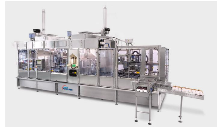
GRUNWALD-Abfüllanlagen mit Ultra-Clean-Technologie: FOODLINER 20.000UC/8-bahnig und - Bild unten - Rotary 20.000UC/3-bahnig
