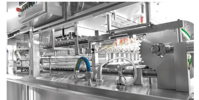
Einblicke in Hochleistungs-Abfüllanlagen: Rundläufer- und Längsläufer-Becherfüller in Ultra-Clean-Ausführung und mit Packstoffentkeimung  $\geq$  LOG 4
