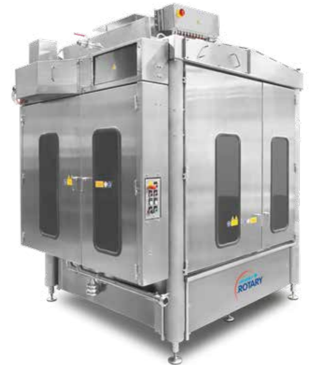
3-bahnige GRUNWALD-ROTARY 12.000UC mit höchstem Hygienelevel zur Abfüllung von Hummus in zahlreichen Variationen
