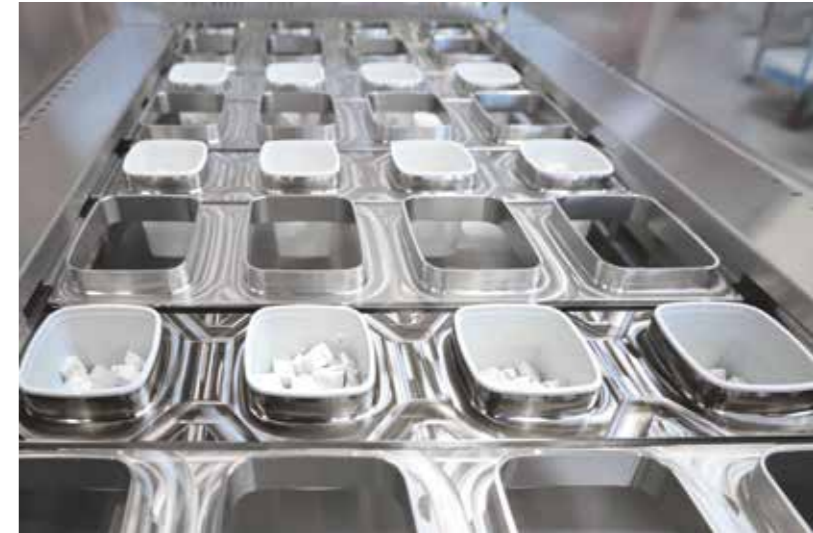
Blick in eine 4-bahnige Becherfüll- und Verschließanlage GRUNWALD-FOODLINER 6.000 in Doppelschrittausführung
